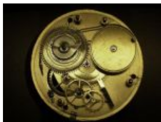
Das Werk überholt und gereinigt
